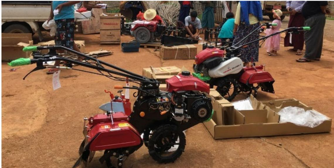
新しく導入されたヤンマー製耕うん機。歩行式なのでトラクターで作業できないような狭い土地を耕すのに適している
